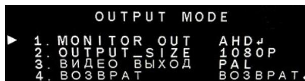
Затем нажмите центральную кнопку и в открывшемся окне выберите пункт «APPLY» для сохранения изменений. Произойдет перезагрузка видеокамеры в выбранный режим работы.
